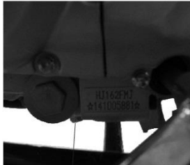
پیچ تخلیه روغن
